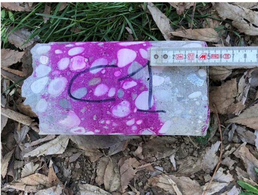
Carota avente uno spessore di carbonatazione medio pari a 5cm.
