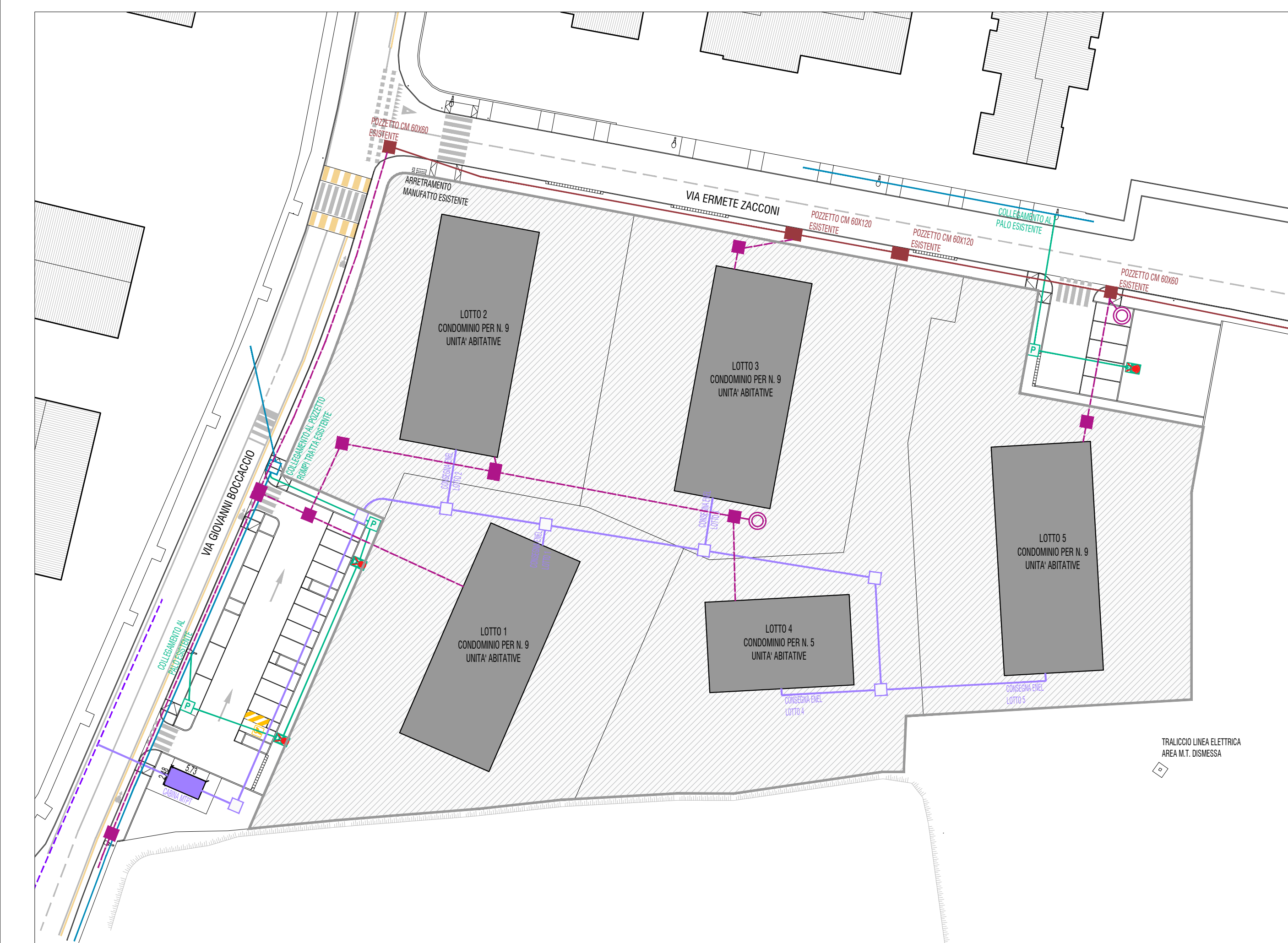
PLANIMETRIA RETE ENEL, RETE FIBERCOF E RETE ILLUMINAZIONE PUBBLICA DI PROGETTO SCALA 1:500
