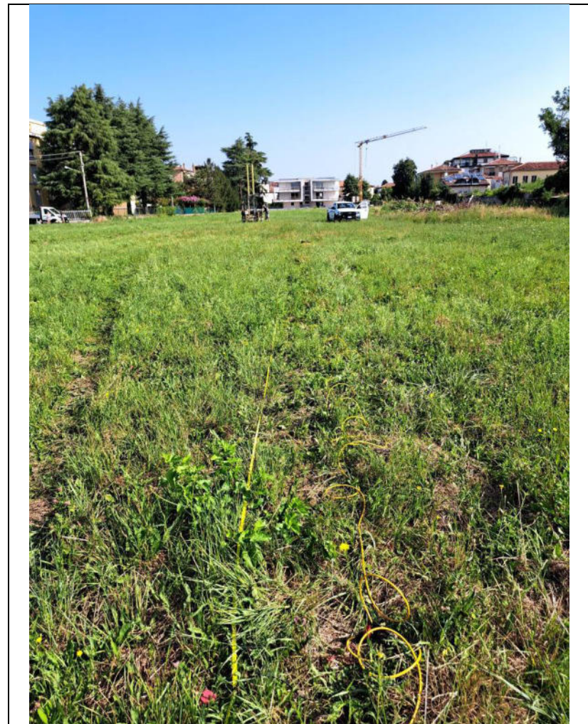
Esecuzione dell'indagine sismica MASW
