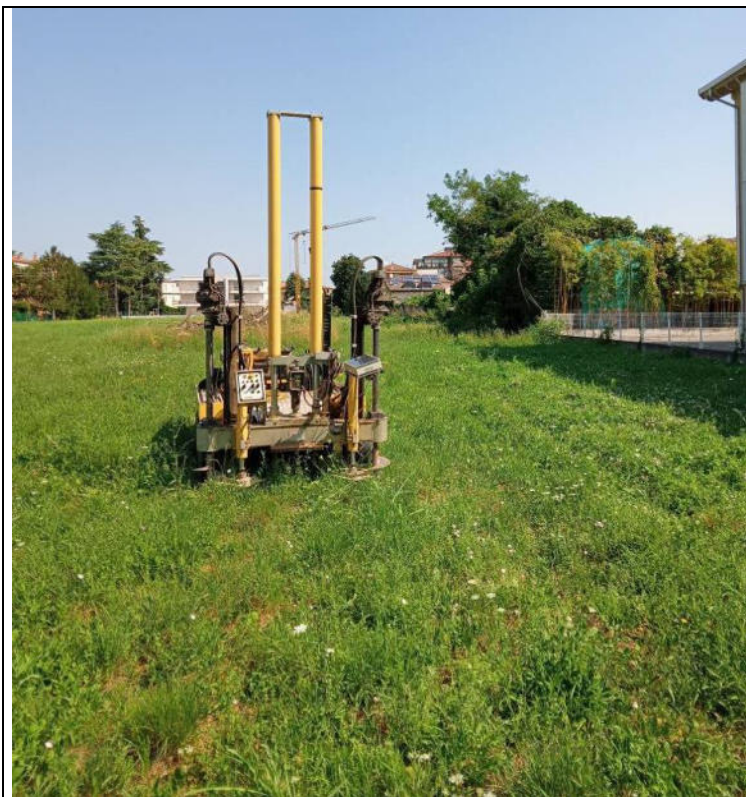
Esecuzione della prova CPTU2
