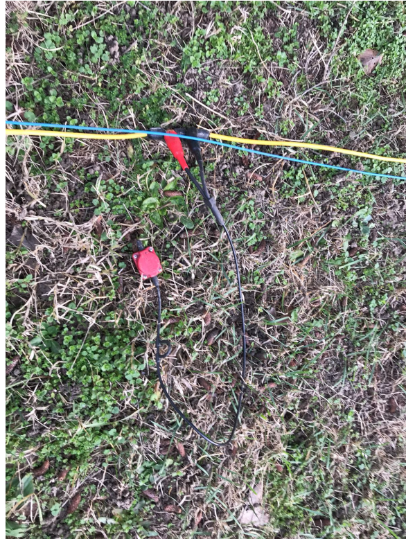
Figura-Geofoni da 4.5 Hz impiegati
