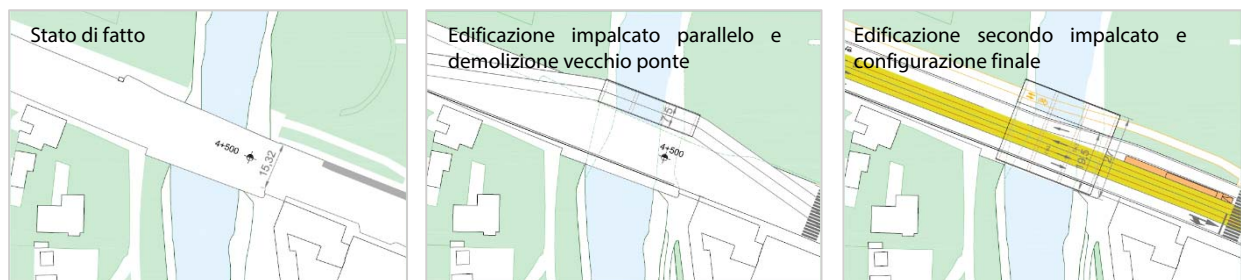
Figura 12_Fasi di sostituzione dell’impalcato sul fiume Brentella
