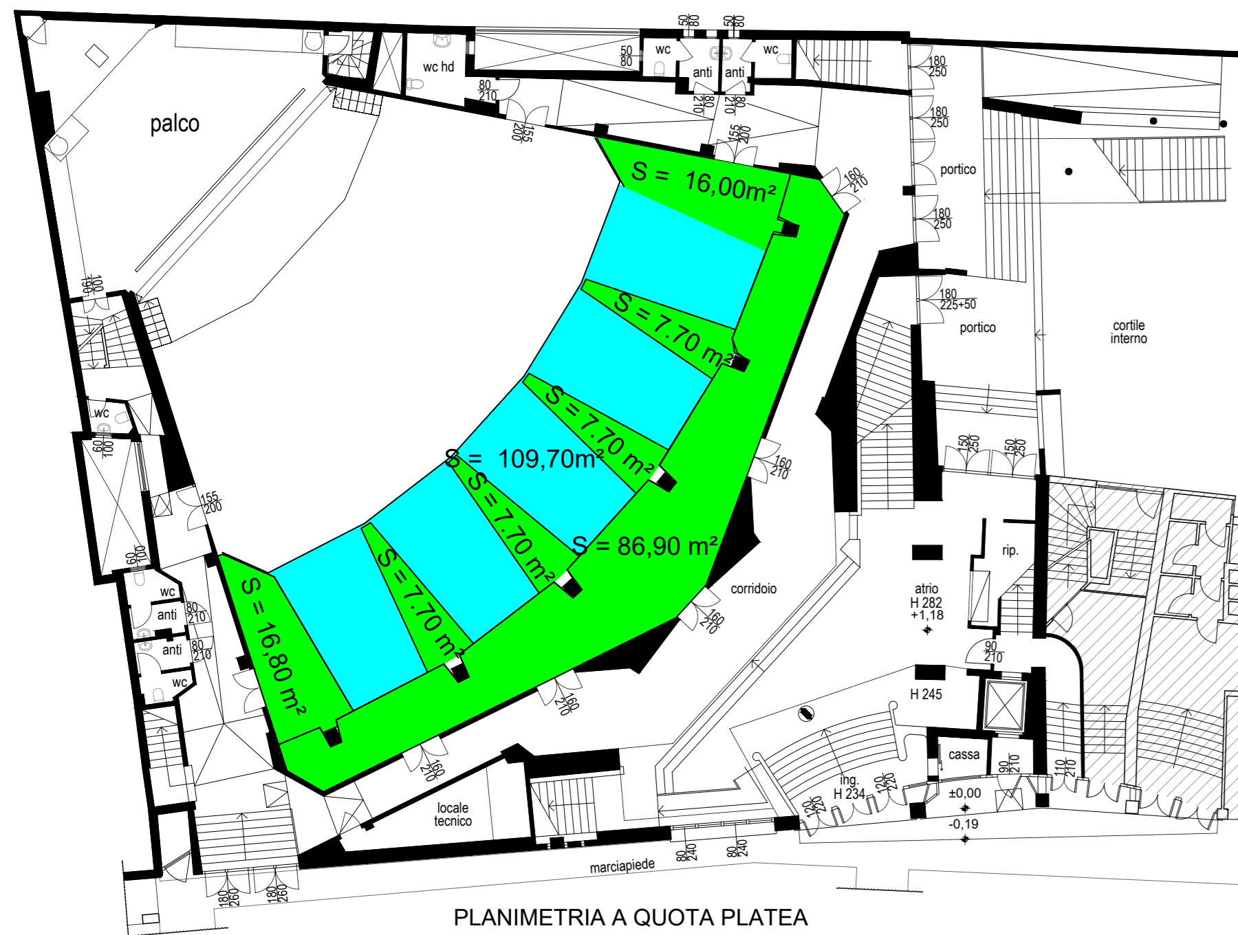
PLANIMETRIA A QUOTA PLATEA DEMOLIZIONE CONTROSOFFITTI E RIVESTIMENTI SOTTO GALLERIA
