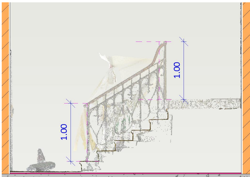
Figura 32 – Estratto nuvola di punti – Scala Edificio B.
