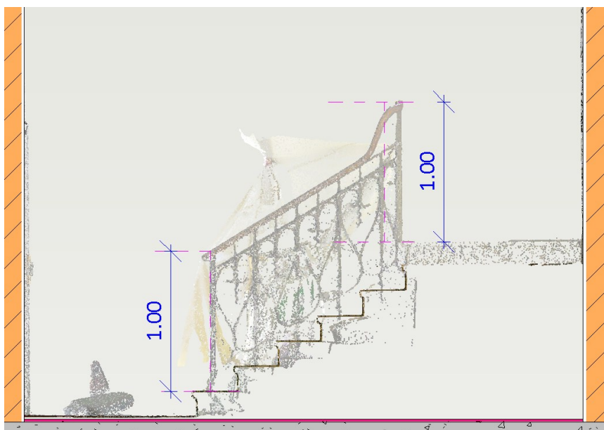
Figura 30 – Estratto nuvola di punti – Scala Edificio B.
