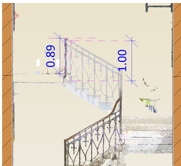
Figura 31 – Estratto nuvola di punti – Scala Edificio B pianerottolo secondo piano.
